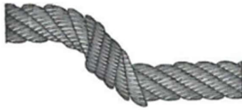
Zdeformowanie liny, wystawianie rdzenia
