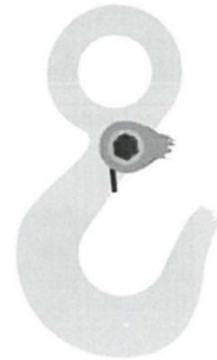
Uszkodzona gardziel, wytłamane zabezpieczenie
