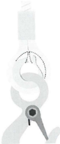
Uszkodzona osłona wewnętrzna pętli
