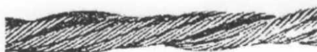
Miejscowe zwiększenie i zmniejszenie średnicy liny, związane ze zniekształceniem lub pęknięciem rdzenia
